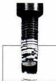
Sezione filettatura spanata sul materiale d'opera
